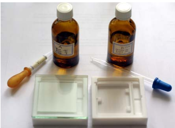
Abbildung 2: Trennkammern und Fläschchen, die die Laufmittel enthalten
