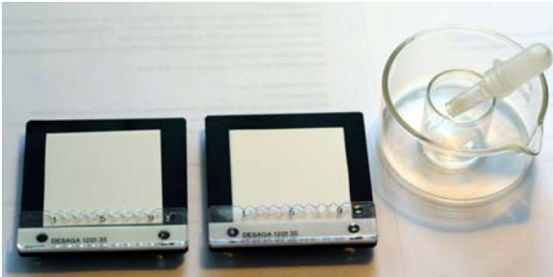
Abbildung 1: Zwei Schablonen mit aufgelegten DC-Platten, Mikrokapillarenhalter in Acetonglässchen zum Reinigen
